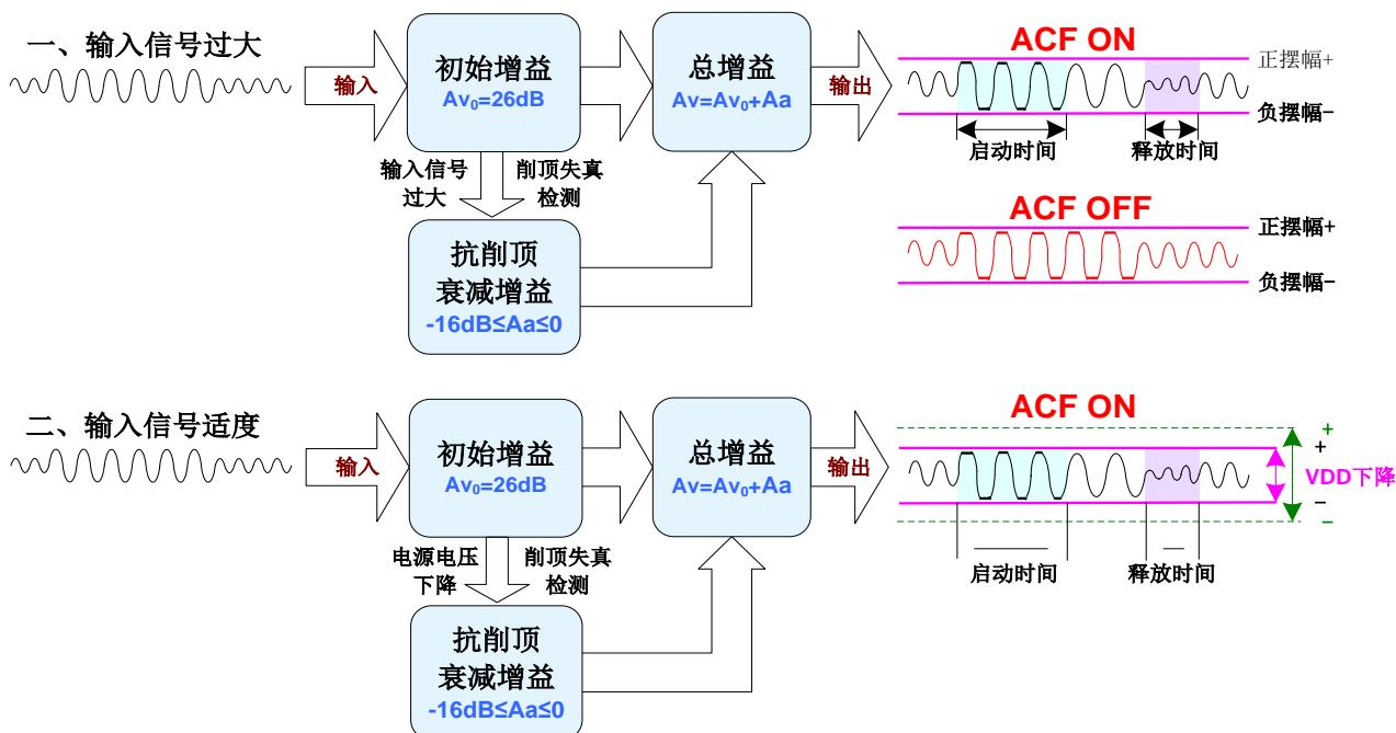
图表 4 ACF 工作原理示意图
